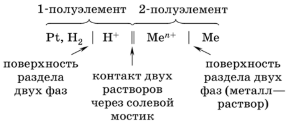
Рис. 7. Схема гальванического элемента со стандартным водородным электродом: 1 — стандартный водородный электрод (первый полуэлемент); 2 — исследуемый электрод (второй полуэлемент); 3 — солевой мостик; 4 — проводник с вольтметром
