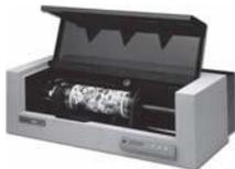
**барабанный** (Drum Scanner) Сканер, в котором оригинал закрепляется на вращающемся барабане. При этом сканируется точечная область изображения, а сканирующая головка движется вдоль барабана на очень маленьком расстоянии от оригинала.
