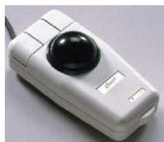
*Трекбол* – устройство ввода информации, которое можно представить в виде перевернутой мыши с шариком большого размера. Принцип действия и способ передачи данных треkbола такой же, как и мыши. Наиболее часто используется оптико-механический принцип регистрации положения шарика. Подключение треkbола осуществляется через последовательный порт.
