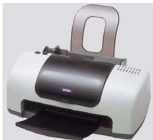
Печатают такие принтеры при помощи направленного потока микроскопических чернильных капель нескольких цветов. Основные технологии, применяемые в струйных принтерах: выброс чернильных капель при нагревании чернил и выброс чернильных капель механически при расширении кристалла под действием электрического тока. Размер чернильных капель и физические свойства чернил определяют качество получаемого изображения. Цветные струйные принтеры бывают класса:
