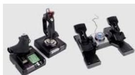
*Джойстик* является координатным устройством ввода информации и наиболее часто применяется в области компьютерных игр и компьютерных тренажеров.
