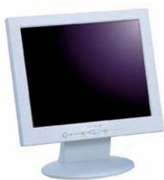
Экран жидкокристаллического дисплея (ЖКД) состоит из двух стеклянных пластин, между которыми находится масса, содержащая жидкие кристаллы, которые изменяют свои оптические свойства в зависимости от прилагаемого электрического заряда (рис. 8). Жидкие кристаллы сами не светятся, поэтому ЖКД нуждаются в подсветке или во внешнем освещении.
