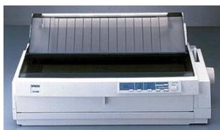
Игольчатый принтер формирует знаки несколькими иглами, расположенными в головке принтера. Бумага втягивается с помощью вала, а между бумагой и головкой принтера располагается красящая лента. При ударе иголки по этой ленте на бумаге остается закрашенный след. Иголочки, расположенные внутри головки, обычно активизируются электромагнитным методом. Головка движется по горизонтальной направляющей и управляется шаговым двигателем.
