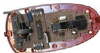
В оптических мышах используются две пары светодиодов и фотодетекторов, устанавливаемых на задней стенке. Одна пара ориентирована под прямым углом по отношению к другой. Подложка покрыта перекрывающимся множеством желтых и голубых координатных сеток. Каждая пара светодиодов и фотодетекторов определяет движение в обоих направлениях при прохождении через соответствующие риски сетки. Специаль-
