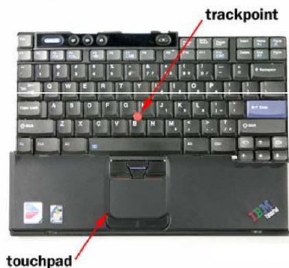
*Тачпад* представляет собой чувствительную контактную площадку, движение пальца по которой вызывает перемещение курсора. В подавляющем большинстве современных ноутбуков применяется именно это указательное устройство, имеющее не самое высокое разрешение, но обладающее самой высокой надежностью из-за отсутствия движущихся частей.
