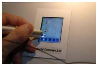
*Световое перо* – светочувствительное устройство, предназначенное для снятия координат точек экрана, ввода данных в информационную систему.
