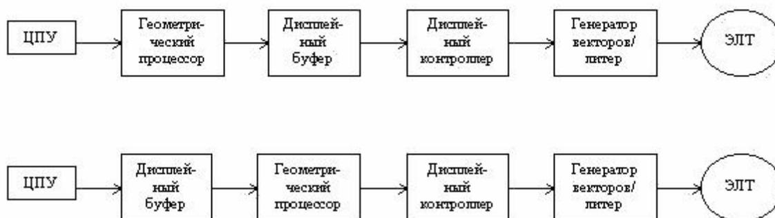
Рис. 1. Блок-схемы векторных дисплеев с регенерацией
