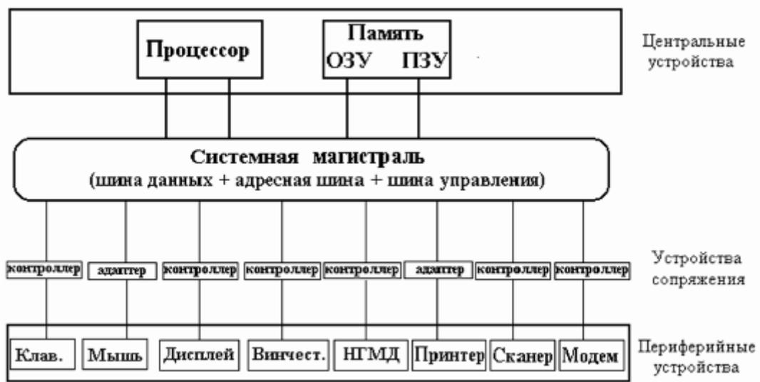
Различные узлы компьютера связаны с микропроцессором и между собой через устройство, которое называется *системной шиной*. Обмен данными происходит через системную шину, которую еще называют *магистралью*.
