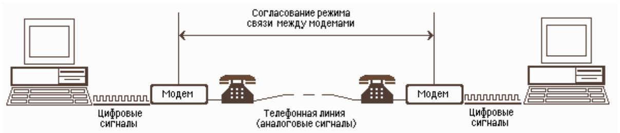
Рис. 12. Схема реализации модемной связи
