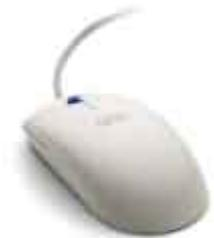
**Мышь** имеет вид небольшой коробки, полностью уместящейся на ладони. Мышь связана с компьютером кабелем через специальный блок — адаптер, и её движения преобразуются в соответствующие перемещения курсора по экрану дисплея. В верхней части устройства расположены управляющие кнопки (обычно их три), позволяющие задавать начало и конец движения, осуществлять выбор меню и т.п.
