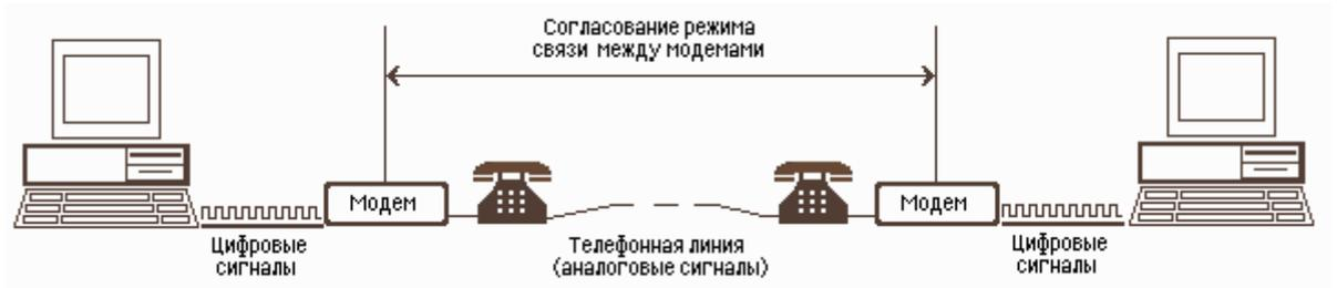
Рис. 12. Схема реализации модемной связи
