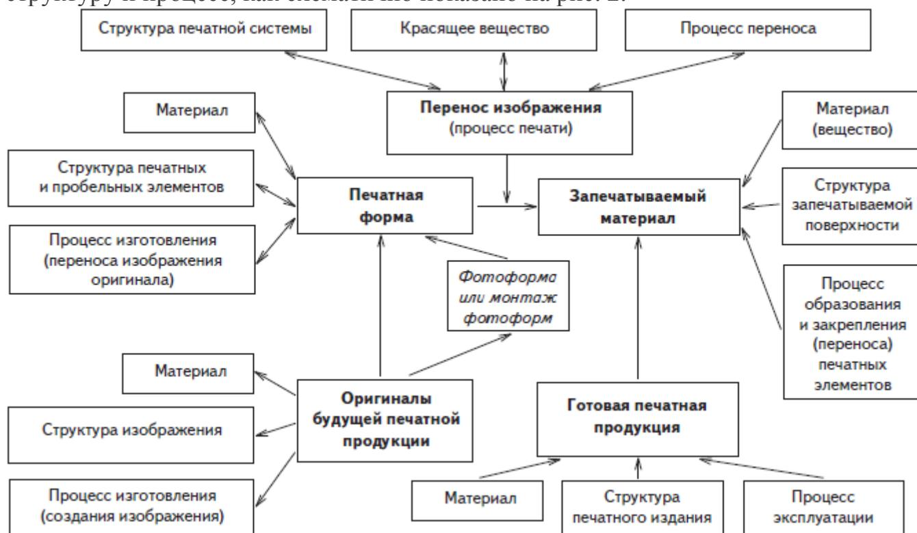
**Рис 2. Структурная схема элементов технологии печатной ее определяющие – оригиналы и готовая печатная продукция**
