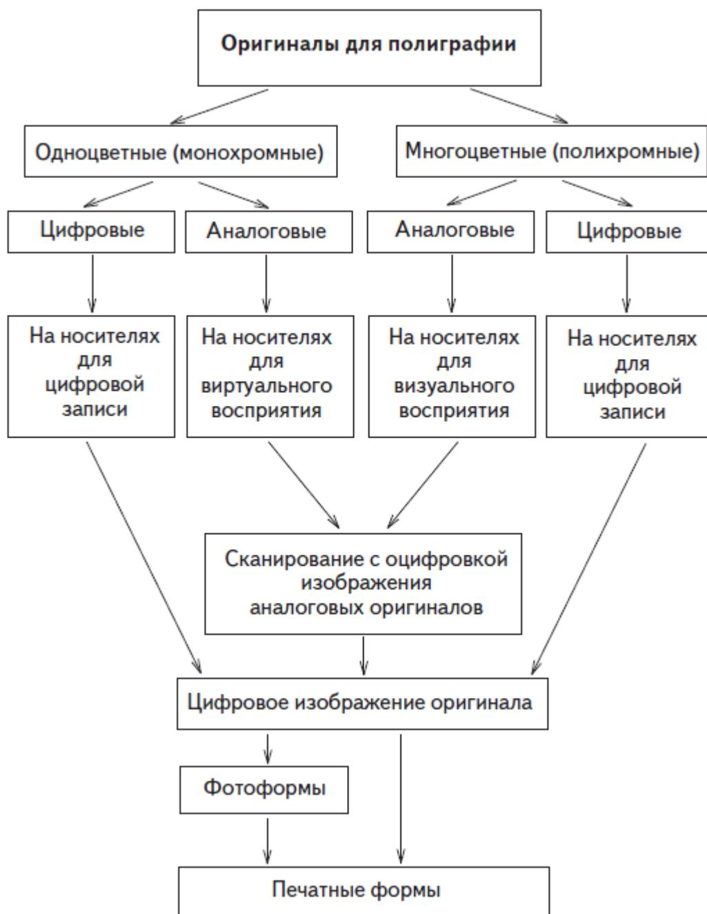
*Рис. 3.* Структурная схема от оригиналов для полиграфии до создания печатных форм включительно
