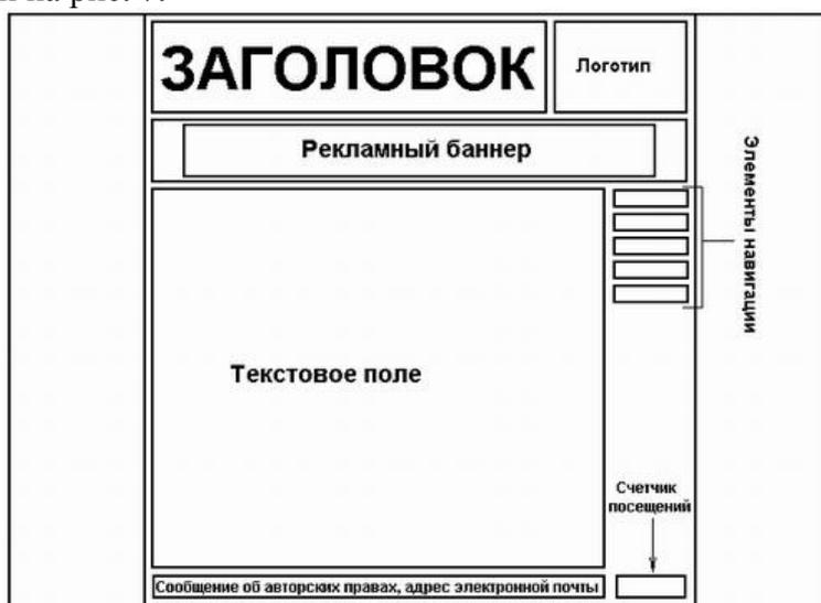
Рис. 7. Пример компоновки web-страницы с правым позиционированием элементов навигации
