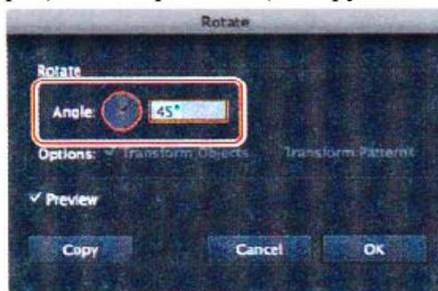
В диалоговом окне Rotate (Поворот) измените значение угла поворота, установив его равным 45°. Щелкните по кнопке ОК.
