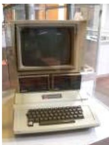
Он был выполнен в пластмассовом корпусе, получил графический режим, звук, цвет, расширенную память, 8 разъемов расширения. Для сохранения программ в нем использовался кассетный магнитофон. Основу первой модели Apple II составлял микропроцессор 6502 фирмы MOS Technology с тактовой частотой 1 МГц. В постоянной памяти был записан Бейсик. Основное достоинство Apple II заключалось в возможности расширения его оперативной памяти до 48 Кбайт.
