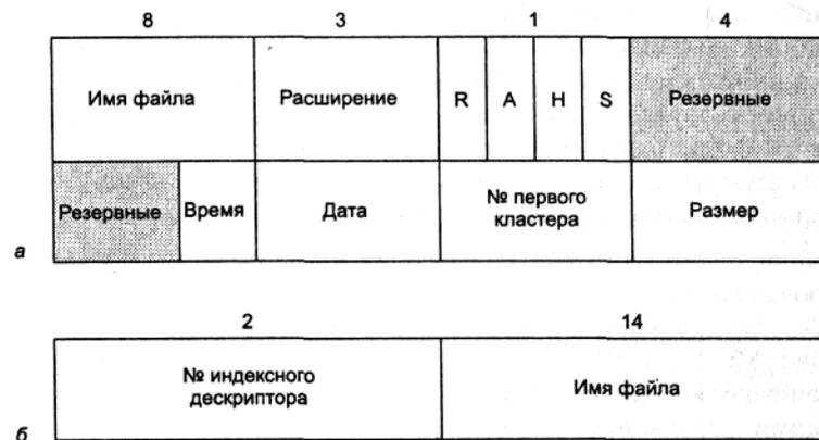
**Рис. 3.6. Структура каталогов: а — структура записи каталога MS-DOS (32 байта), б — структура записи каталога ОС UNIX**
