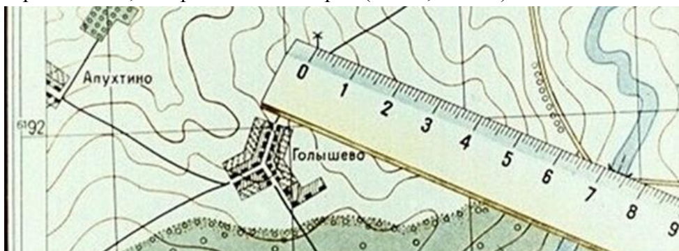
Рис. 2. Определить по карте расстояние между точками местности с помощью линейки.
