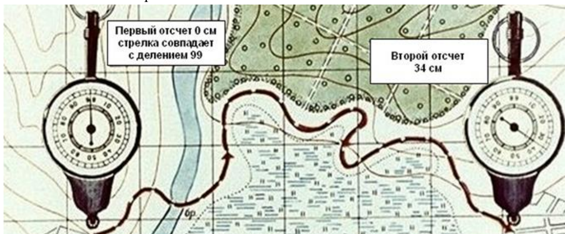
Рис. 5. Измерения расстояния курвиметром
