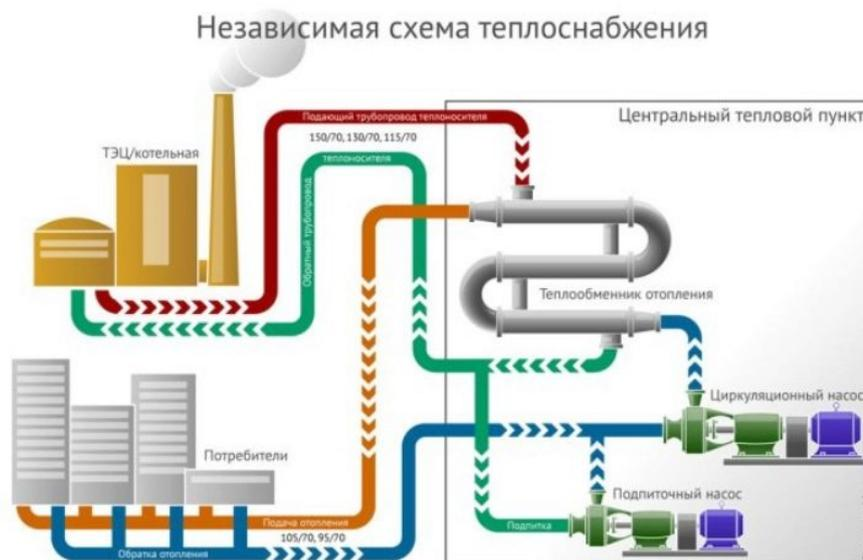
**Рис. 16.4. Независимая система теплоснабжения**
